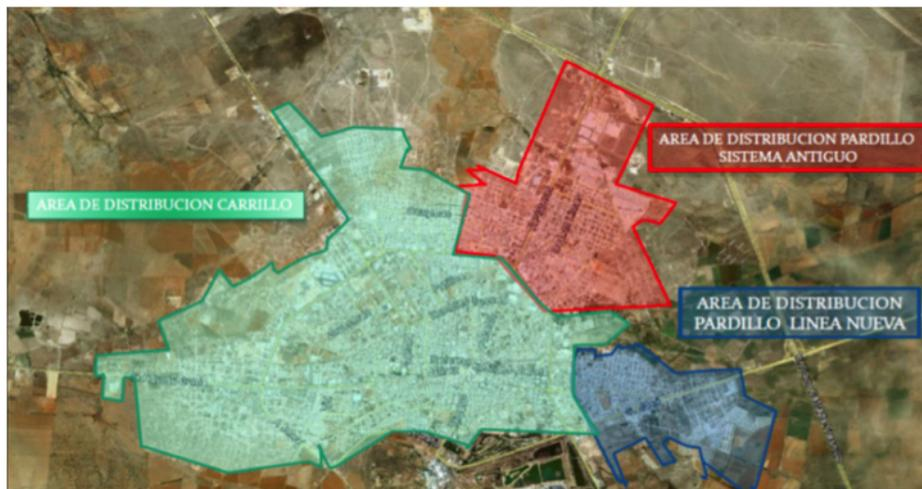
Nueva distribución de agua potable con el nuevo rebombeo del sistema pardillo a través de línea de conducción de 14”.
